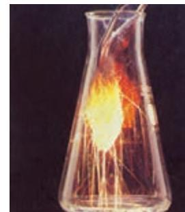
ث) محلول هیدروژن پراکسید در دمای اتاق به کندی تجزیه شده و گاز اکسیژن تولید می‌کند، در حالی که افزودن دو قطره از محلول پتاسیم یدید، سرعت واکنش را به طور چشمگیری افزایش می‌دهد.
