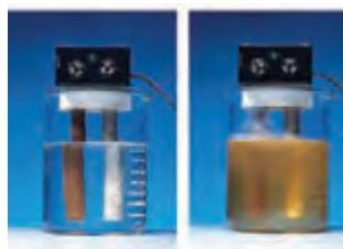
در این آزمایش با عبور جریان برق از درون آب آشامیدنی و انجام واکنش، برخی یون‌ها از تیغه‌های فلزی وارد آب شده و سبب تغییر رنگ آن می‌شوند. توجه کنید که این آزمایش، میزان یون‌های موجود در آب را به درستی نشان نمی‌دهد.
