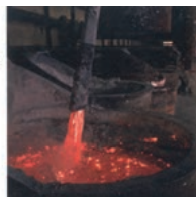
شکل ۱۸- فرایند هال برای تولید آلومینیم از \text{Al}_2\text{O}_3
